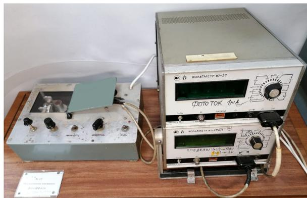
Рис. 6.2. Экспериментальная установка по исследованию внешнего фотоэффекта
